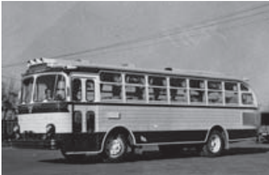
「ホームバス」のベース車となったB X91-X型のバス。ボンネット型が中心の時代、キャブオーバー型バス自体が珍しい存在だった(写真提供・いすゞ自動車)
